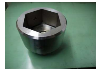
対辺200mm (MCで荒加工後) 六角放電加工
