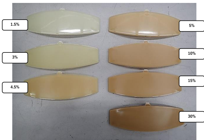
CNFの配合比率を変えたテストピースを製作
