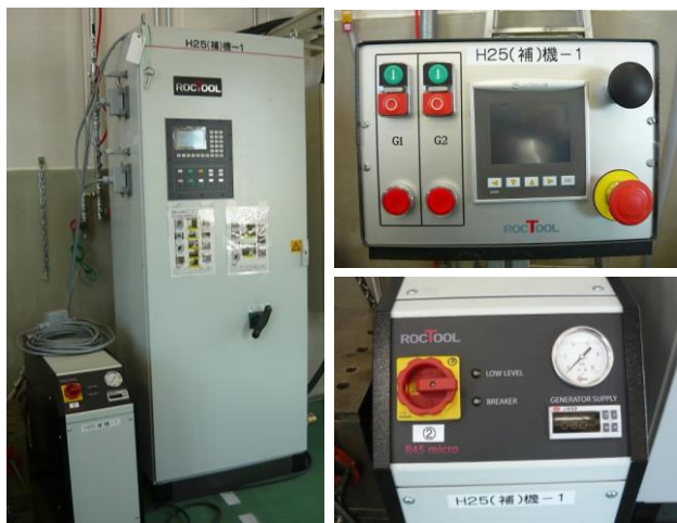
ヒート&クール電磁誘導加熱装置 (RocTool社製)
