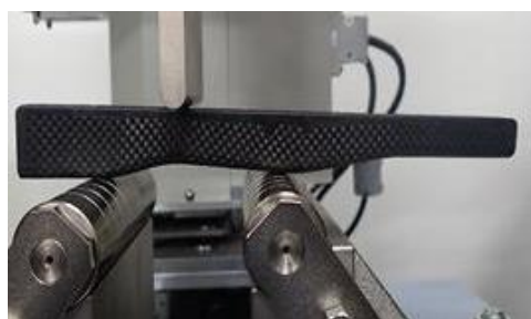
成形サンプルと3点曲げ破壊強度試験
