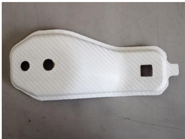
樹脂織布積層板をプレス～射出と同時に成形
