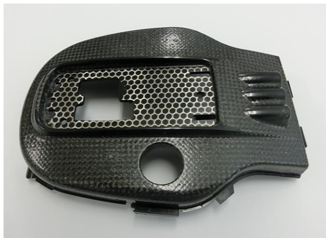
シフトカバー成形品 (表面: プリプレグ材プレス・金属インサート)
