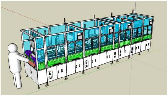
装置概要: HDD 組立工程のHSA組立自動化Line
