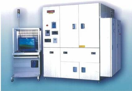
装置概要: ウエハー、パッケージ品の配線修正。CVDガス雰囲気中でレーザを走査して金属配線を付加形成する。
