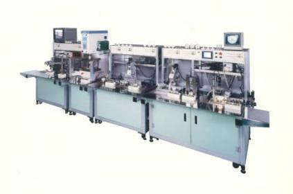
装置概要: ハードディスク用流体軸受モーターの組立装置。
