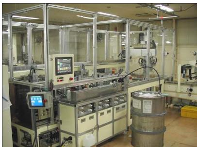
装置概要: インクカートリッジへインクを注入、製品ROMへのデータ書込みラベル貼りを自動で行い、次工程の梱包機へ払い出す。
