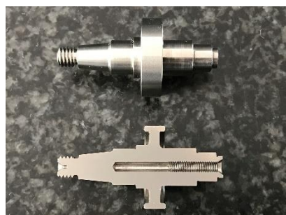
チタン合金深穴加工（φ2長さ35mm）
