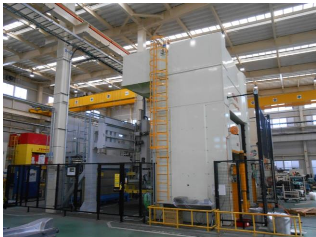
1000t油圧プレス機に設置(テーブル3500×2500 ストローク1700)
