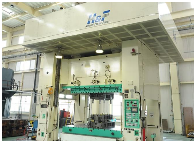
トライ:1000tメカプレス機 (テーブル2000×3500 ストローク800)
