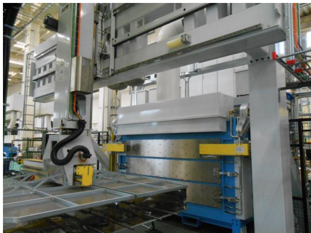
加熱炉(3段仕様)・自動搬送ロボットシステム(AP&T社製)
