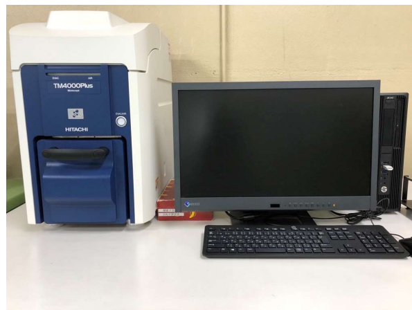
SEM/EDX HITACHI 型式：TM4000Plus
