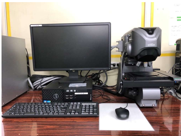
形状解析レーザー顕微鏡 KEYENCE 型式：VK-X250
