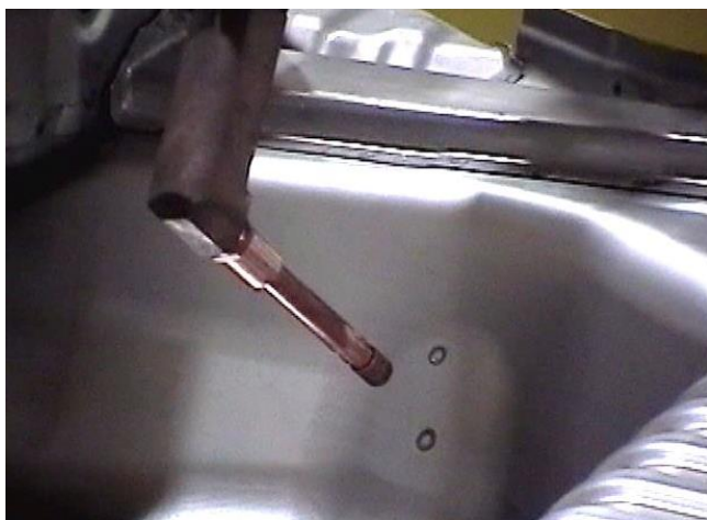
スポット溶接部分のアップ
