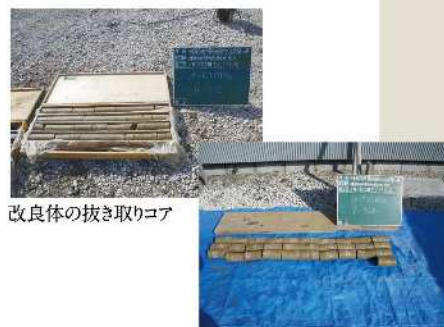
改良体の全長コア 抜き取り状況
