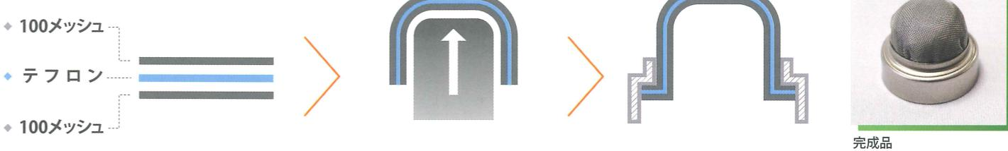
通常それぞれ独立した部品となるストレーナーを、絞り込む時の力を円周状に均等に分散することで、微妙な調整で材料同士をきれいに織り込み、剥がれのない一本ストレーナーとして製品化しました。極細線材の破線しやすい多層メッシュ構造でありながら無給油、無洗浄での加工を可能にし、地球環境に適した加工となっています。無洗浄化の成功により、異種素材であるテフロンシートを金属メッシュの間に挟み加工することができより高付加価値製品の提案を可能にしました。
